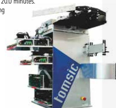
**easy** 是TOMSIC的均匀度测试仪，100%意大利制造，用于棉条，粗纱，纱线的均匀度测定和分析。由于采用了最先进的技术，最简易的操作，无维护成本以及合理的价格... **easy**是你最佳的选择！
